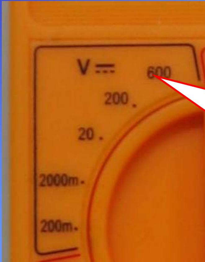
Choisir le calibre le plus grand : 600V pour ne pas détériorer le multimètre
